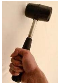
4. Ayuda a compactación del material
